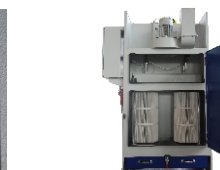
Integrierte Absaugung mit Patronenfilter 0,55 KW und Staubschublade
