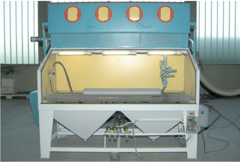
Injektorstrahlkabine mit Patronenfilter Absaugung Injection Cabine with Cartridge Filter Device
